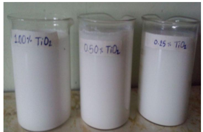
Fig. 2.2: TiO 2 Nano Fluid prepared
