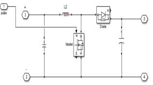
Fig:9 Boost Converter Subsystem
