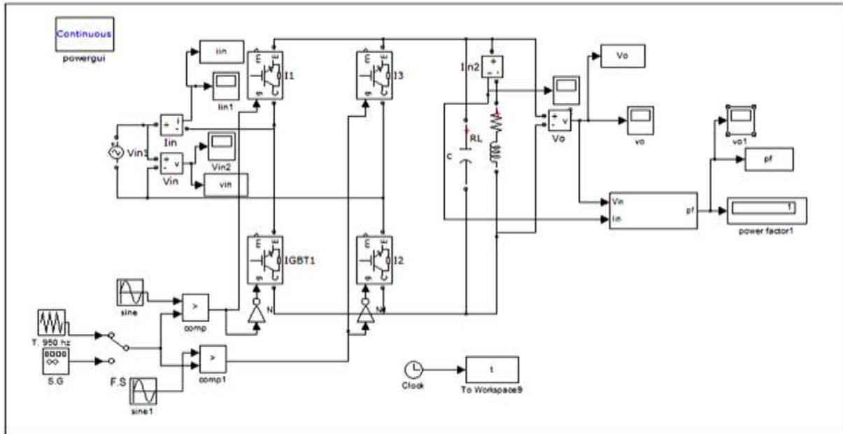
**Fig 3:- Single phase PWM rectifier**
