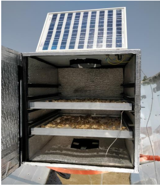
Fig. 2 solar dryer actual model
